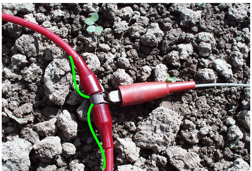
Figur 2.1 Foto med illustration af et kabeludtag, og af hvordan en leder i mangelederkablet principielt er forbundet. (grønne streger).
